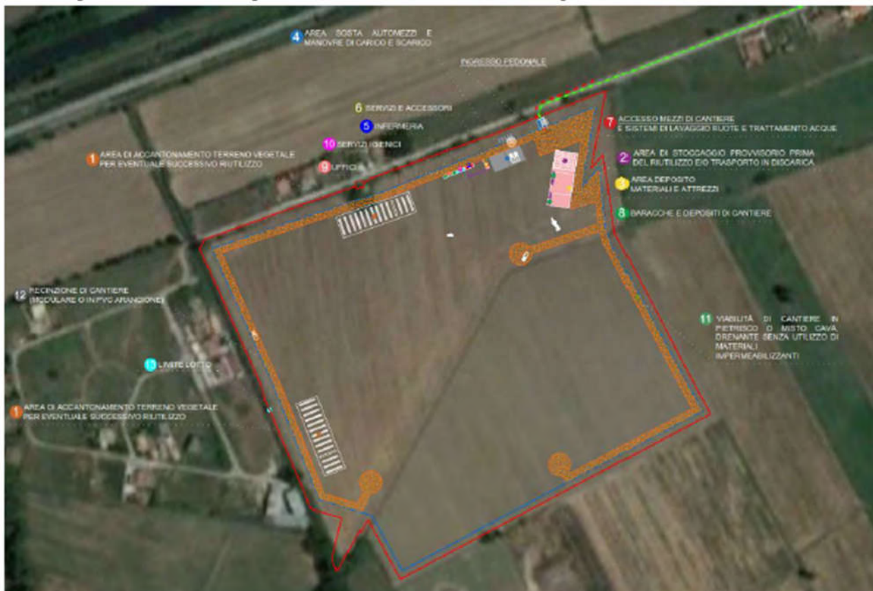
Figura 14 – layout di cantiere
