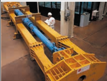
Prove presso il laboratorio FIP su un dissipatore viscoso per il Rion-Antirion Bridge (Grecia).
