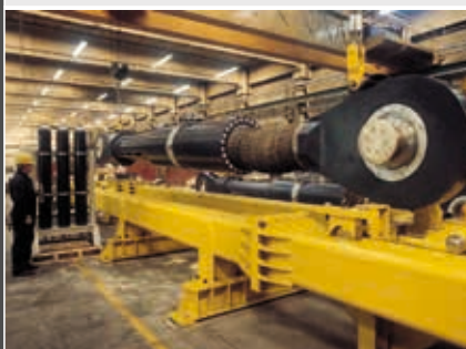
Allestimento delle prove su un dispositivo di vincolo dinamico per lo Storebælt Bridge (Danimarca).
