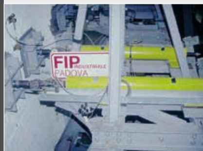
Prove su tavola vibrante su pareti in muratura con dispositivi SMAD usati come tiranti orizzontali.
