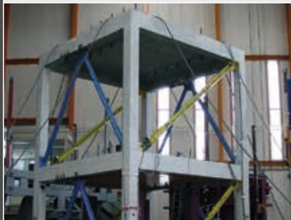
Prove su tavola vibrante su un telaio in c.a. con dissipatori EVED alla sommità del controvento a V rovescia.
