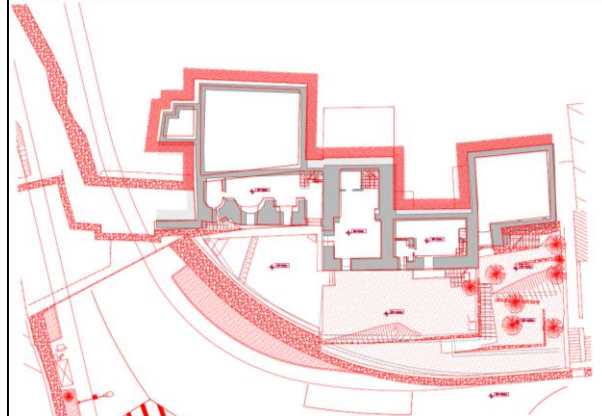
Fig.37 - Sovrapposizione Topografico e Rilievo progetto definitivo, quota -9,05 m
