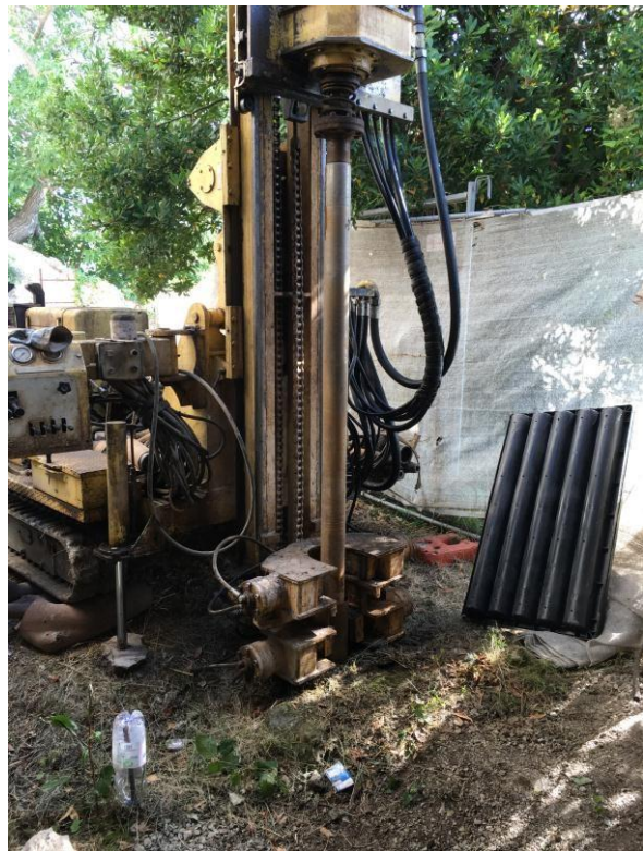
Figura 8a b: fase carotaggio 2
