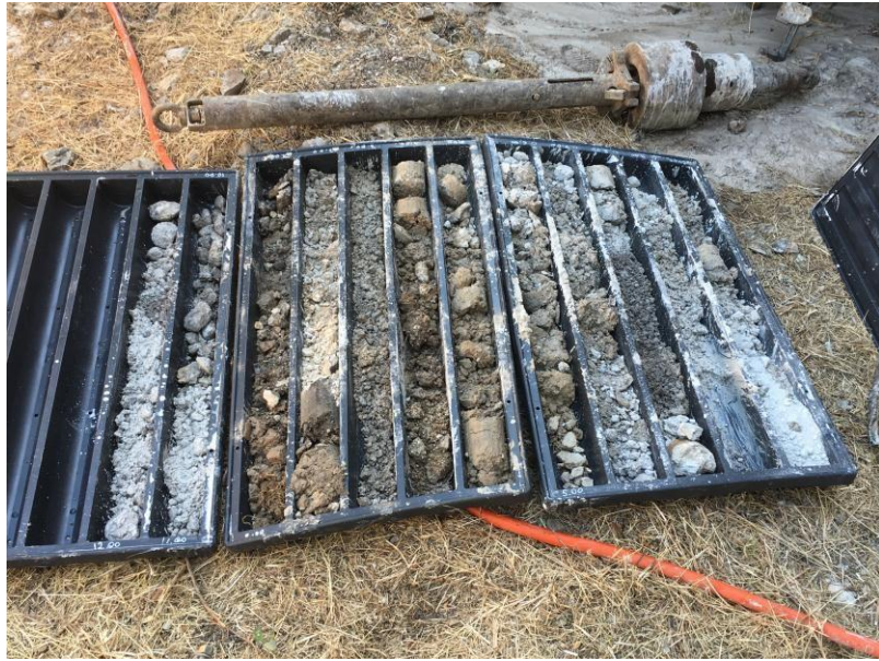
Figura 7: carote da 0 a 12 mt
