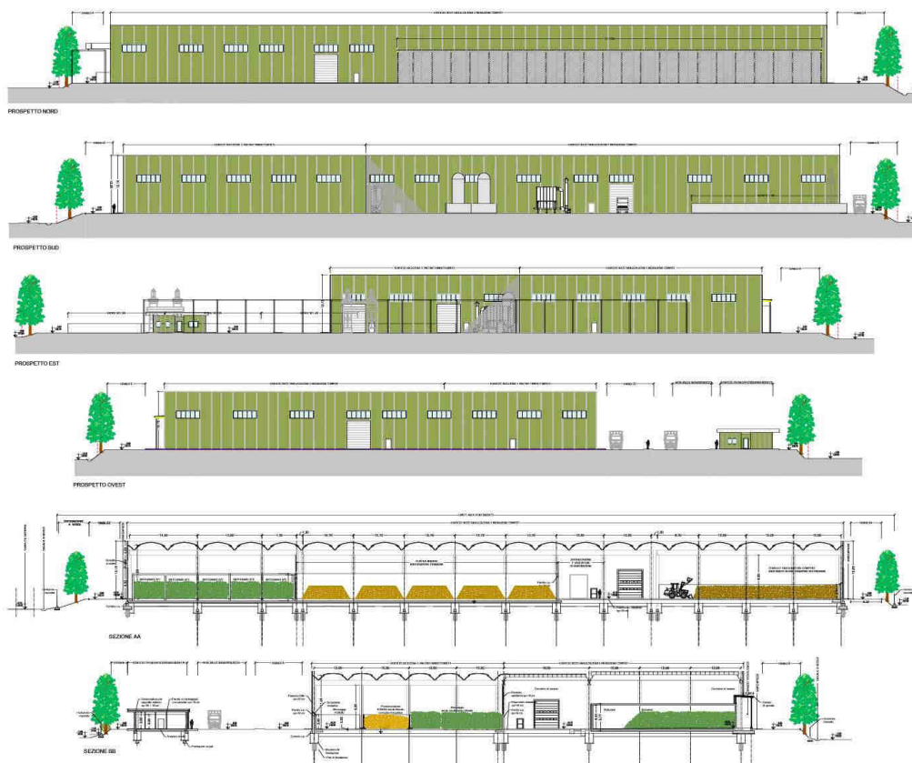
Figura - 17. Prospetti e sezioni capannone principale
