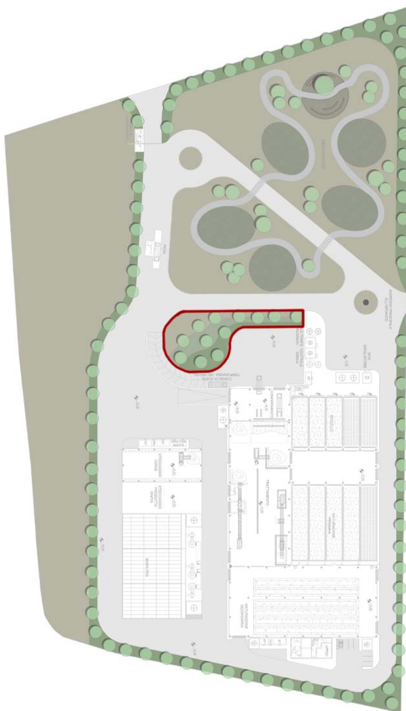
FIGURA 8-43 – OPERE A VERDE - PLANIMETRIA. SI NOTA LA SIEPE PERIMETRALE LUNGO TUTTO IL PERIMETRO ESTERNO DEL PIAZZALE E, EVIDENZIATA IN ROSSO, L'AREA A MACCHIA MEDITERRANEA.
