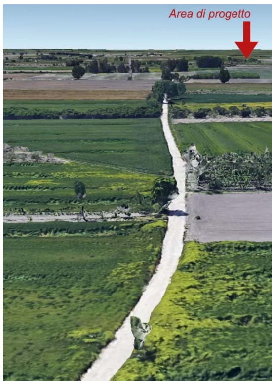
FIGURA 2-6 – VIABILITÀ PER MEZZI PESANTI: STRADA COMUNALE PRIMO LIMETONE (LARGHEZZA 4 M).
