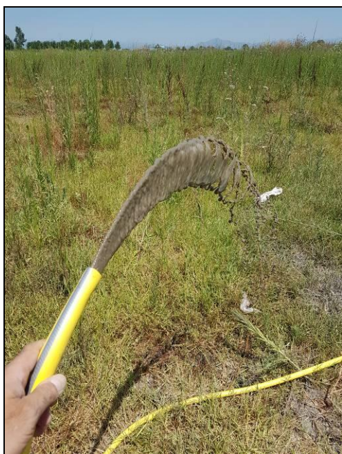
Spurgo piezometro: chiarificazione acqua emunta
