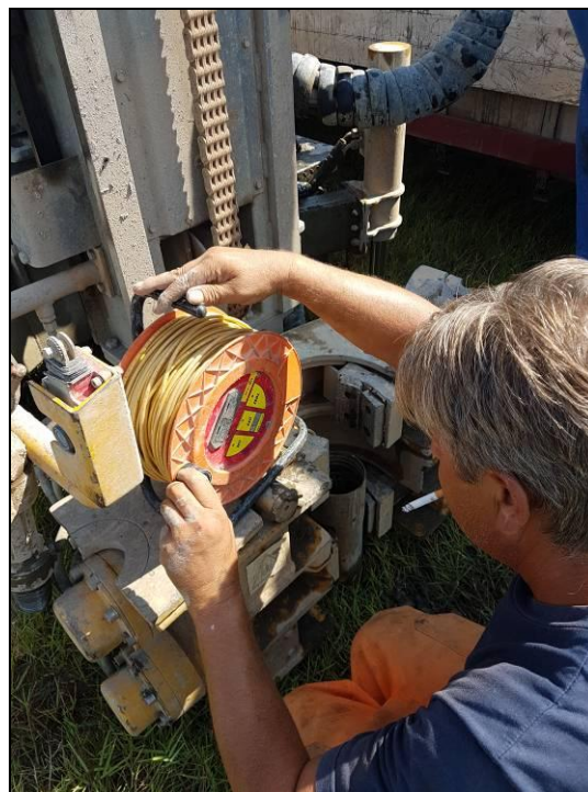
Misura livello di falda
