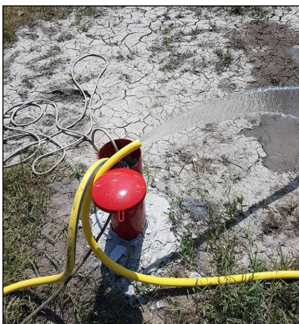
Condizionamento foro di sondaggio con piezometro a T.A.
