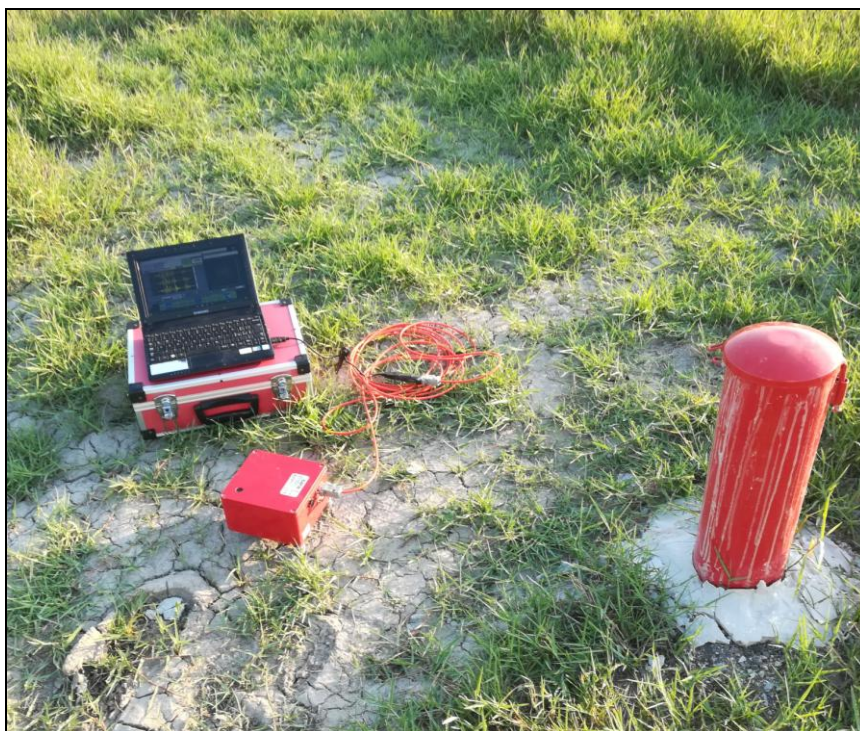
Indagine Sismica HVSr
