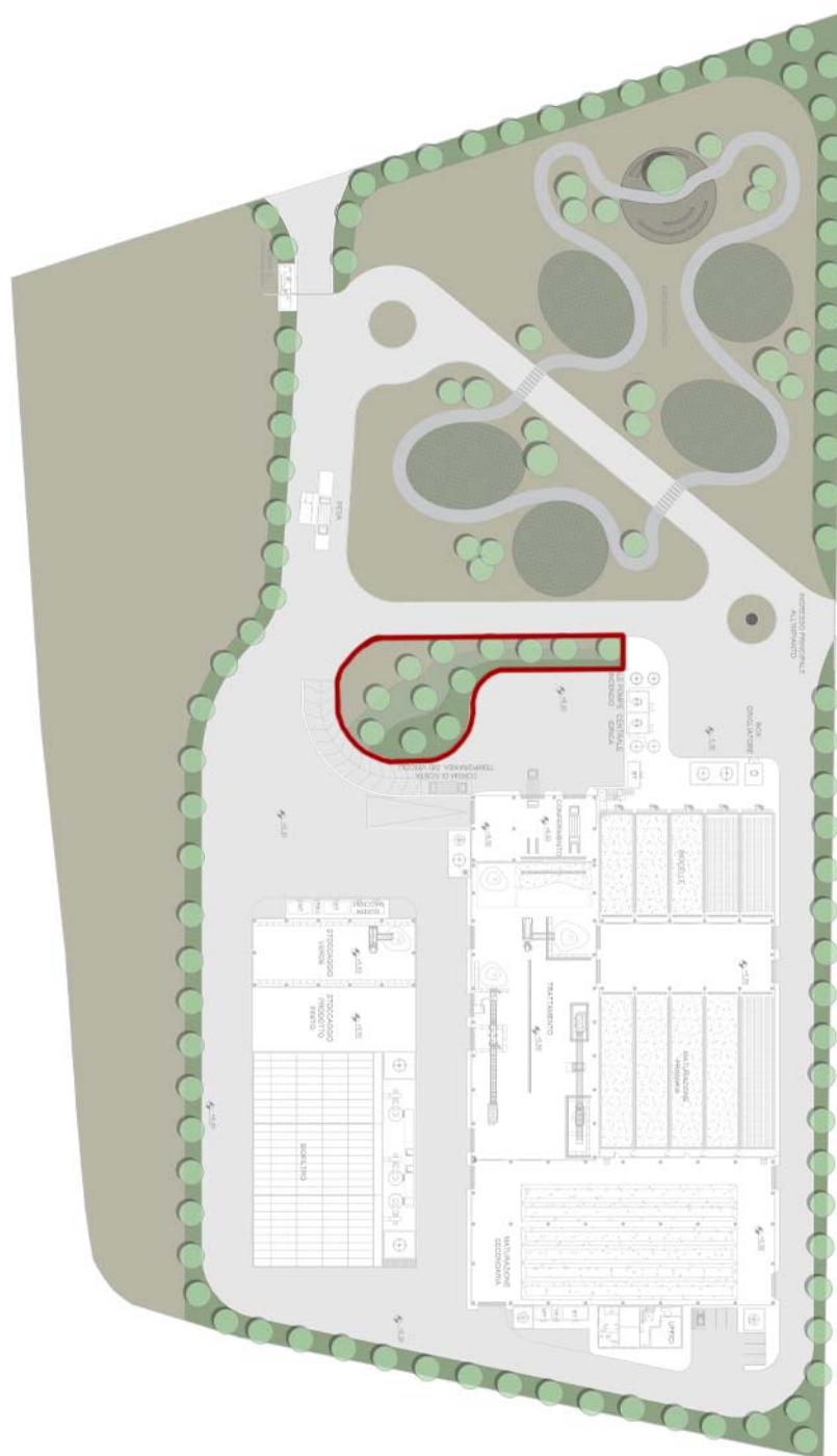
FIGURA 4-38 – OPERE A VERDE - PLANIMETRIA. SI NOTA LA SIEPE PERIMETRALE LUNGO TUTTO IL PERIMETRO ESTERNO DEL PIAZZALE E, EVIDENZIATA IN ROSSO, L'AREA A MACCHIA MEDITERRANEA.
