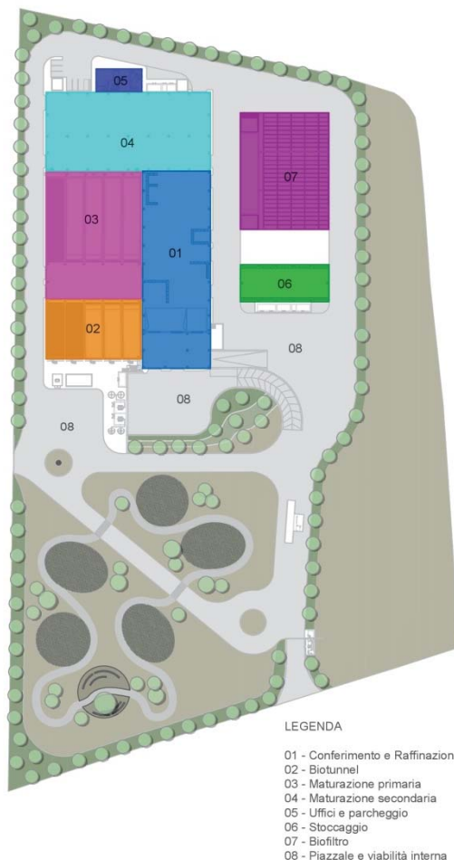
FIGURA 3-1 – LAYOUT SCHEMATICO DELL'IMPIANTO IN PROGETTO.
