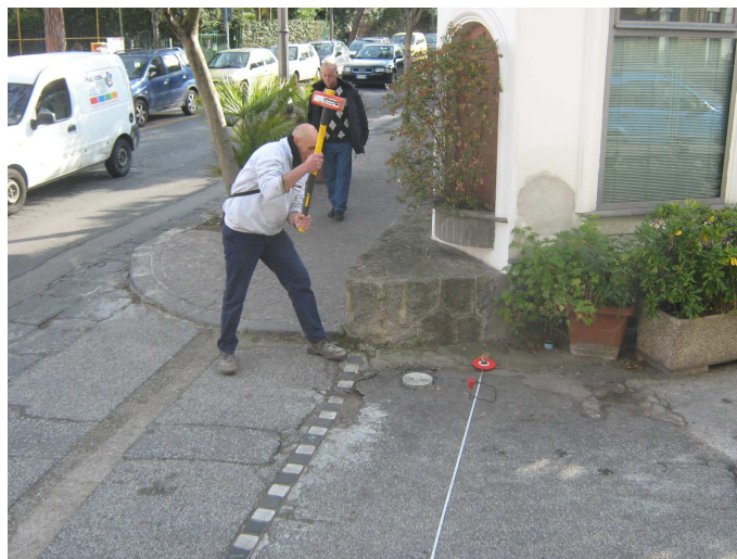
Foto 1 – Sorgente energizzante, costituita da massa battente su piastra di alluminio.
