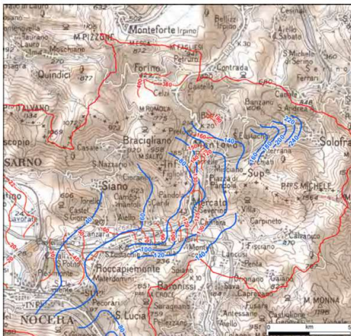
Figura 4: Curve piezometriche (in m s.l.m.) nell'acquifero carbonatico (blu) ed in quello piroclastico-alluvionale (rosso) della piana del T. Solofrana – dalla Tav. 9 in Piano Stralcio di Tutela delle Acque - Autorità di Bacino del Sarno, 2004. Il limite rosso esterno è quello dell'AdB del Sarno.
