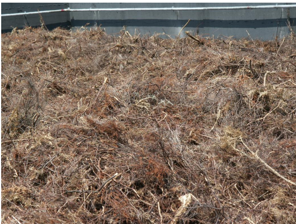
Figura 3 - Materiale filtrante Biomix ® – torba ed erica
