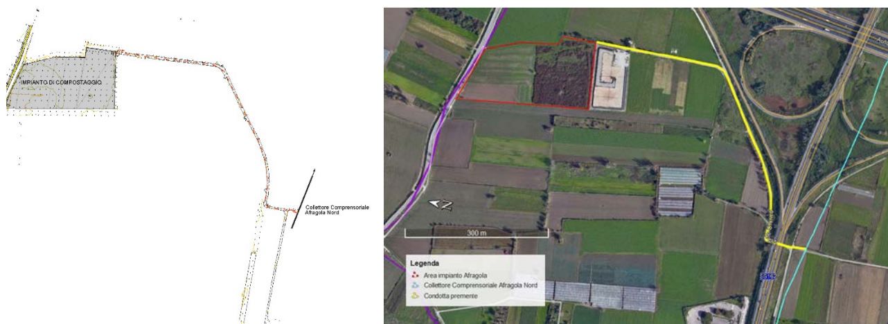
Figura 7 - Tracciato della condotta premente dall'impianto al Collettore Afragola Nord su rilievo topografico e su base Google Earth
