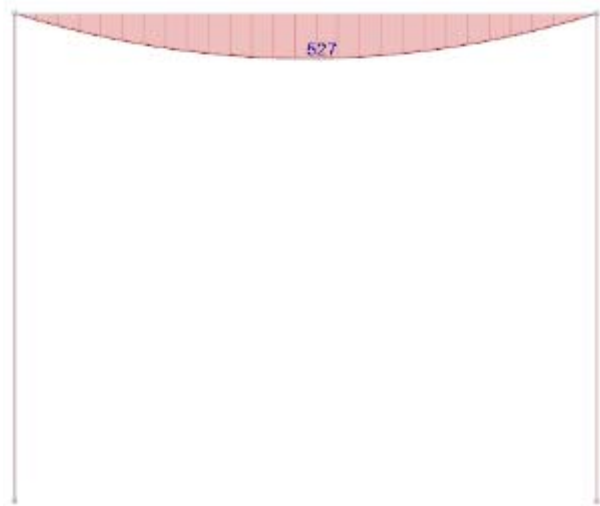
Diagramma momenti in condizione “permanentI portati”[kNm]
