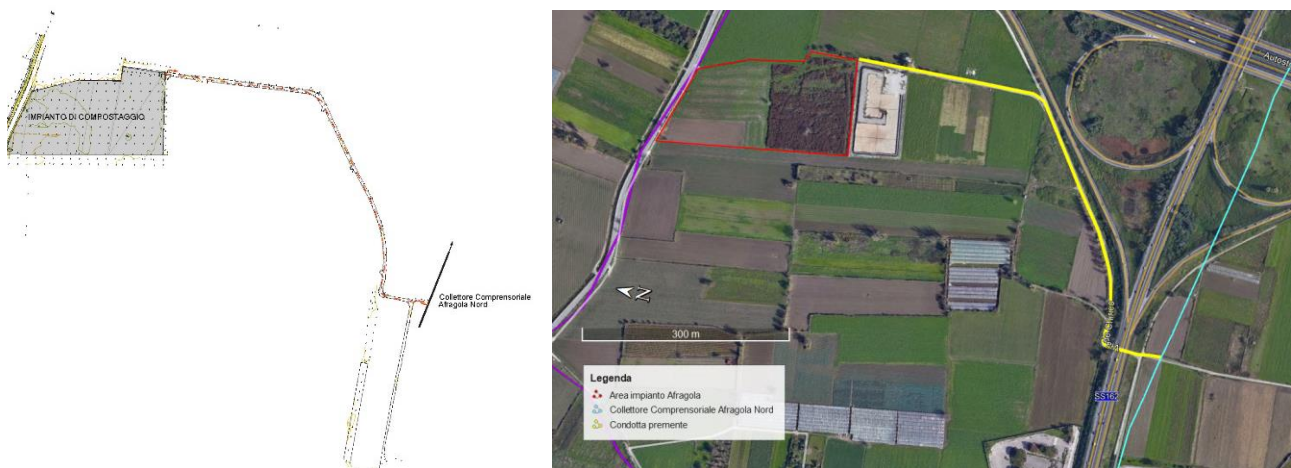
Figura - 13. Tracciato della condotta premente dall'impianto al Collettore Afragola Nord su rilievo topografico e su base Google Earth
