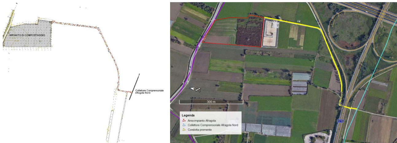
Figura - 27. Tracciato della condotta premente dall'impianto al Collettore Afragola Nord su rilievo topografico e su base Google Earth
