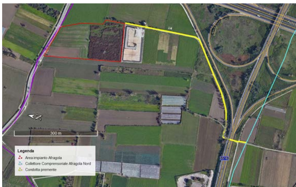
Figura - 2. Inquadramento del collettore di scarico acque
