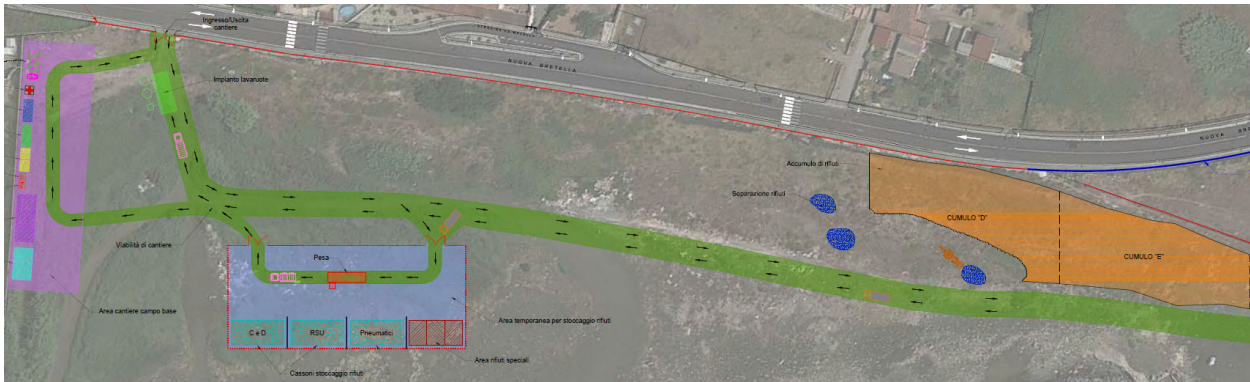
Figura 16 Fase 5. Smantellamento Cumulo D
