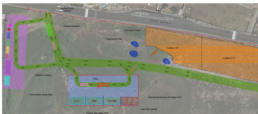
Figura 4 Fase 3. Smantellamento Cumulo B
