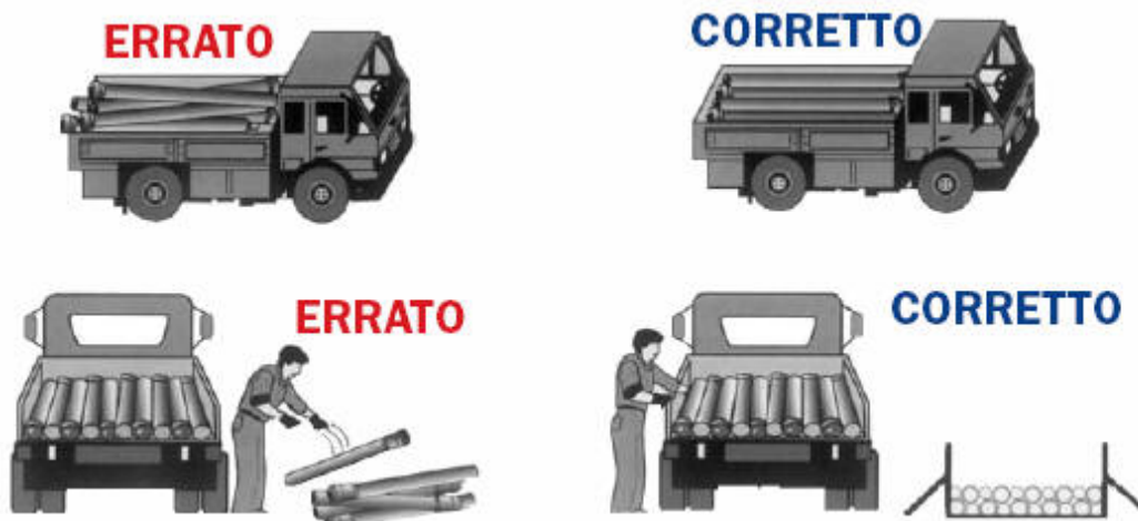
modalità di stoccaggio tubazioni su mezzi di trasporto in cantiere
