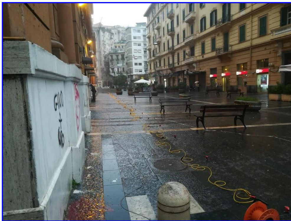
Fig. 1 – Prospezione sismica MASW effettuata in area progettuale.
