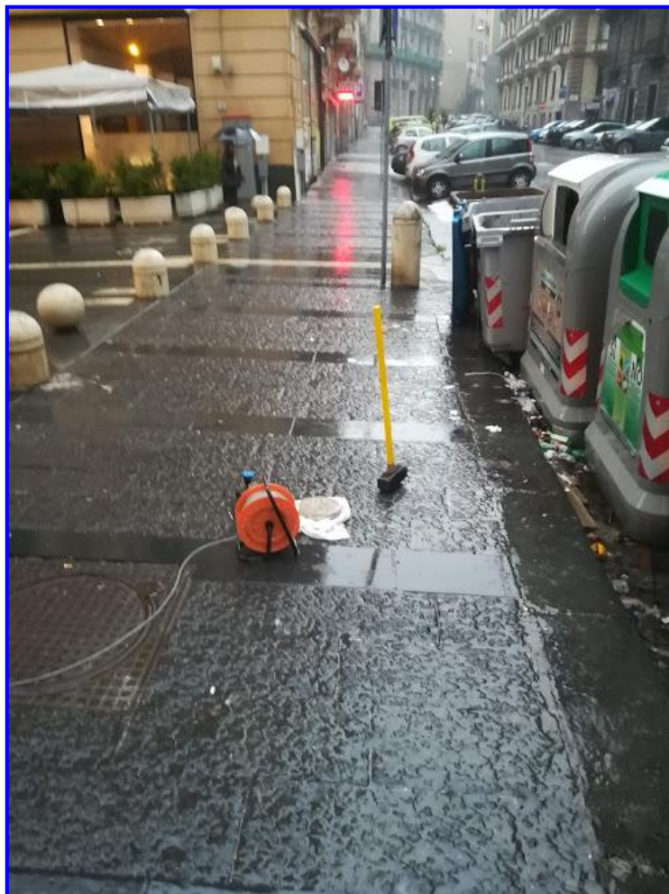
Fig. 2 – Sorgente energizzante, costituita da massa battente su piastra di alluminio. Come starter/trigger è stato utilizzato un geofono verticale Geospace a 14Hz.
